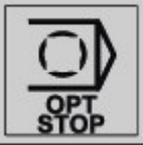
– если нажата кнопка «OPT STOP», производится условный останов по команде M1 в управляющей программе.
