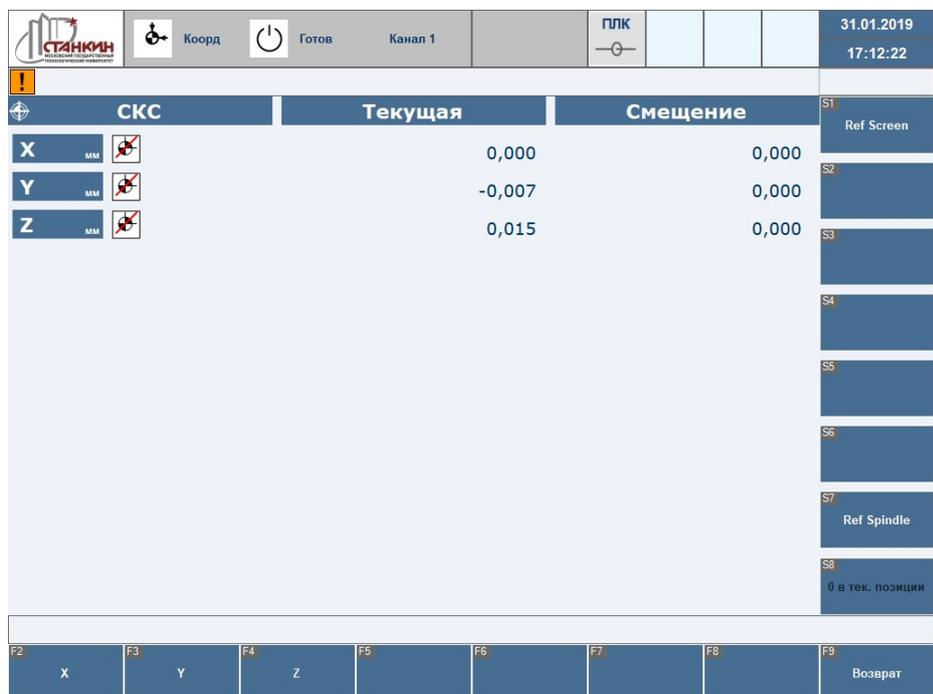
**Рисунок 11 – Вид окна экрана оператора в режиме привязки осей**
