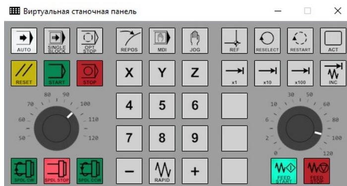
Рисунок 2 – Виртуальная станочная панель эмулятора системы ЧПУ «АксиОМА Контроль»
