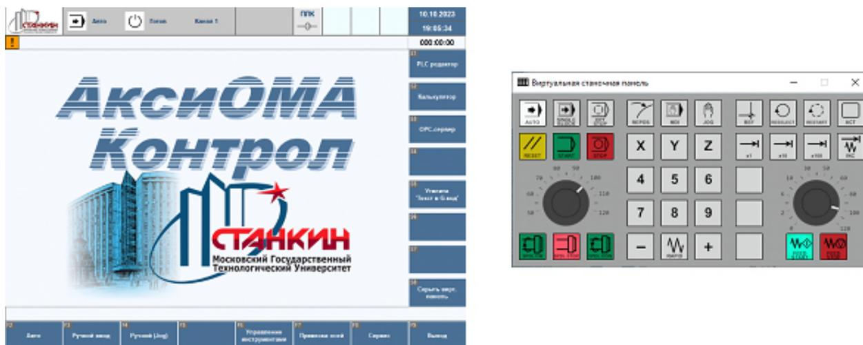
Рисунок 1 – Терминальная часть эмулятора системы ЧПУ «АксиОМА Контроль»
