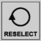
– если нажата кнопка «RESELECT», по окончании выполнения УП автоматически производится её повторный выбор.
